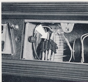
09-4 - Emplacement des fusibles sur CA (basculante).
