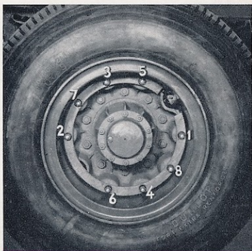
06-13 - Ordre de serrage des écrous de roues AR.
