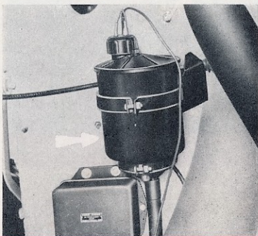
05-7 - Emplacement du réservoir de liquide de servo-direction sur CSA.
